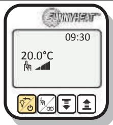
Si ve la palabra "OFF" en la esquina superior derecha, su ISTC está apagado y la calefacción no calienta.
