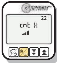
Drücken Sie auf der Ansichtebene so oft die 2. Taste, bis der Wert mit dem Betriebsstundenzähler-Symbol angezeigt wird.
