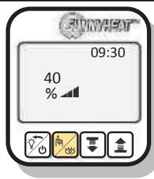
Drücken Sie auf der Ansichtebene so oft die 2. Taste, bis der Wert mit dem Prozent-Symbol angezeigt wird.
