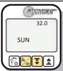
Drücken Sie kurz auf die 2. Taste auf der Hauptebene, so dass Sie die aktuelle Temperatur sehen.
