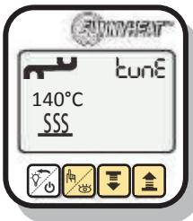
Drücken Sie im Tune-Menü so oft die 2. Taste, bis Sie das Strahlungstemperatur-Symbol sehen.
