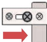
Die Arretierungsbleche in Position „Offen“ drehen, das Heizpaneel einhängen und bis zum Anschlag in die angegebene Pfeilrichtung schieben.
