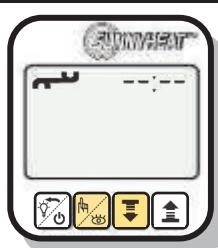
En el nivel de configuración, pulse la segunda tecla hasta ver el símbolo de reloj en la esquina superior derecha.
