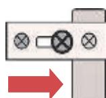
Turner les tôles de blocage en position <<Ouvert>>, accrocher le panneau de chauffage et le faire glisser jusqu'à la butée dans le sens de la fléché .
