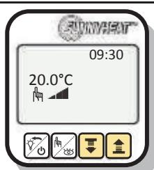
La température désirée est la température à laquelle votre panneau de chauffage SUNNYHEAT doit chauffer. Elle est située au-dessus du symbole de la main.
