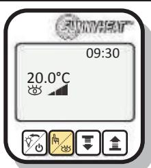
La température actuelle est la température actuellement mesurée dans la pièce par l'ISTC.
