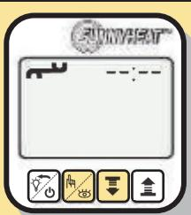
Door gelijktijdig op de tweede en de derde toets te drukken komt u van het hoofdniveau in het weergaveniveau. Druk in het weergaveniveau nogmaals de tweede en derde toets gelijktijdig in, om naar het instelniveau te gaan. U herkent het instelniveau aan het gereedschaps symbol in de linkerbovenhoek.
