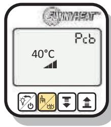
Drücken Sie auf der Ansichtebene so oft die 2. Taste, bis der Wert mit dem Pcb-Symbol angezeigt wird.
