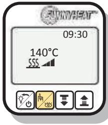
En el nivel de vista general, presione la segunda tecla hasta que se muestre el valor con el símbolo de irradiación.
