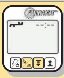
Pulsando simultáneamente la segunda y tercera tecla, puede pasar del menú principal al de visualización. En el nivel de visualización, pulse otra vez la segunda y tercera teclas simultáneamente para acceder al nivel de configuración. Puede reconocer el nivel de configuración por el símbolo de la herramienta en la esquina superior izquierda.
