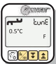
Dans le menu Tune, appuyez sur la 2e touche jusqu'à ce que le symbole Protection contre le gel apparaisse.
