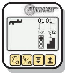
Die Ampelschaltung ist nun von unten nach oben gewechselt. Das bedeutet, dass Sie das Enddatum der Abwesenheit einstellen.
