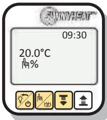
Als u de toetsblokkering hebt ingeschakeld, kunt u via de pijltjestoetsen geen op-ties meer wijzigen op de ISTC. De toetsblokkering schakelt u in/uit door op het hoofdniveau de volgende toetscombinatie uit te voeren: eerste toets en derde toets tegelijkertijd indrukken, en vervolgens de tweede toets indrukken en tenslotte op de eerste toets drukken.
