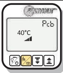
En el nivel de vista general, presione la segunda tecla hasta que se muestre el valor con el símbolo de Pcb.
