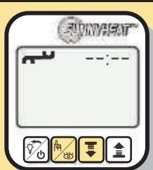
Durch gleichzeitiges Drücken der 2. und 3. Taste gelangen Sie von der Hauptebene in die Ansichtebene. Drücken sie auf der Ansichtebene noch einmal die 2. und 3. Taste gleichzeitig, um in die Einstellebene zu gelangen.
