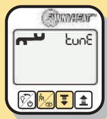
Pulsando simultáneamente la segunda y tercera tecla, puede pasar del menú principal al de visualización. En el nivel de visualización, pulse otra vez la segunda y tercera teclas simultáneamente para acceder al nivel de configuración. A continuación, pulse la segunda tecla hasta ver en la esquina superior derecha la palabra "Tune".
