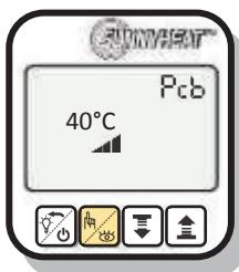
Druk in het weergaveniveau net zolang op de tweede toets, totdat de waarde met het Pcb-symbool wordt weergegeven.
