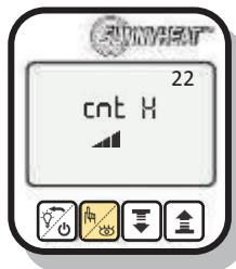
En el plano de visualización, pulse la segunda tecla hasta que se muestre el valor con el símbolo de contador de horas de funcionamiento.
