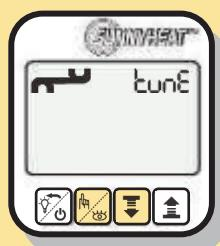
Durch gleichzeitiges Drücken der 2. und 3. Taste gelangen Sie von der Hauptebene in die Ansichtebene.
