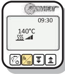
Druk in het weergaveniveau net zolang op de tweede toets, tot de waarde met het symbool van het stralingsniveau wordt weergegeven.
