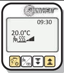
Para activar/desactivar el control parental, presione la primera y cuarta teclas en el menú principal simultáneamente. Si el fusible está activo, la temperatura de radiación está limitada a 60 °C, de manera que se reduce el riesgo de quemaduras para los niños en el vidrio caliente. Cuando el bloqueo para niños está activado, aparece bajo la temperatura deseada el ícono de temperatura de la radiación.
