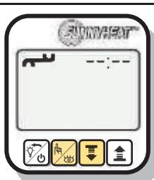
Au niveau réglage, appuyez sur la 2e touche jusqu'à ce que le symbole Heure apparaisse dans le coin supérieur droit. Appuyez simultanément sur les 2e et 3e touches pour accéder au menu.
