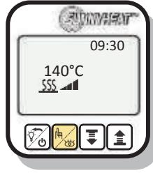
Drücken Sie auf der Ansichtebene so oft die 2. Taste, bis der Wert mit dem Strahlungstemperatur-Symbol angezeigt wird.
