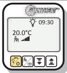
Si su panel de calefacción SUNNYHEAT está equipado con luces, puede encender o apagar la luz pulsando brevemente la primera tecla.
