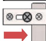
Girar las chapas de inmovilización en posición abierta, colgar el panel de calefacción y empujarlo hasta el tope en la dirección indicada de las flechas .
